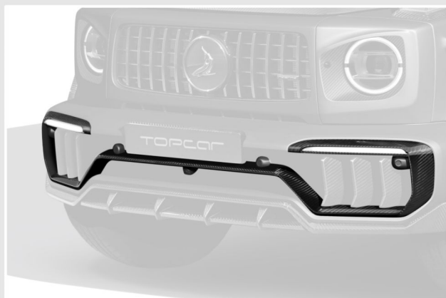
4. Центральный спойлер переднего бампера с каркасом и вставками под LED-огни
